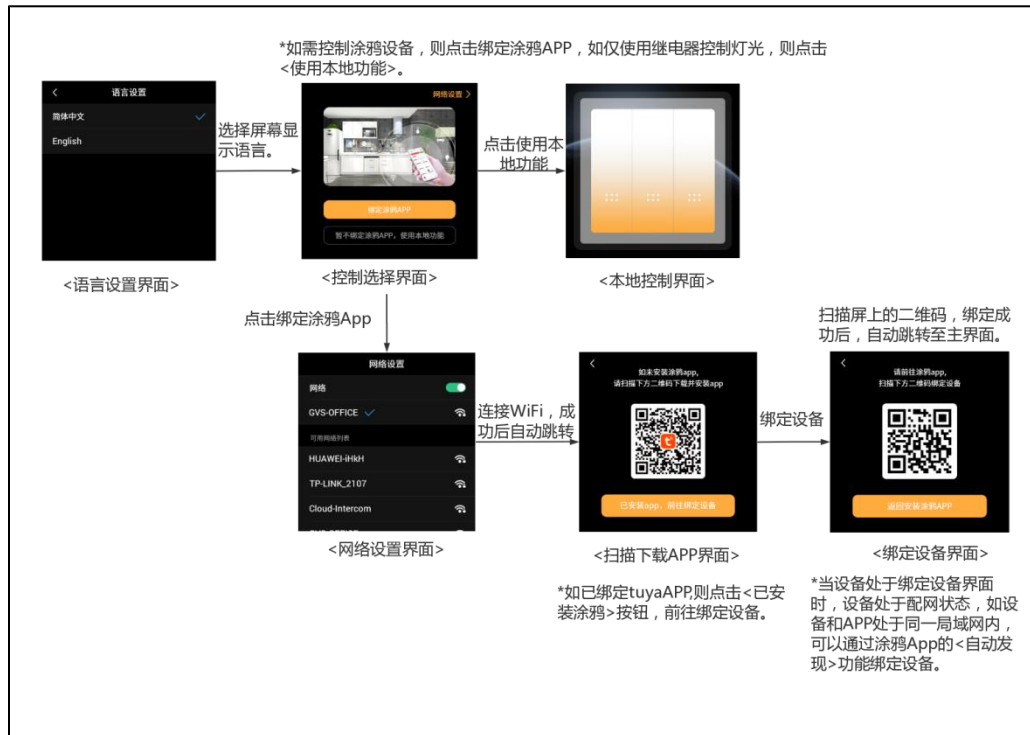
图 1 首次上电配置流程图
