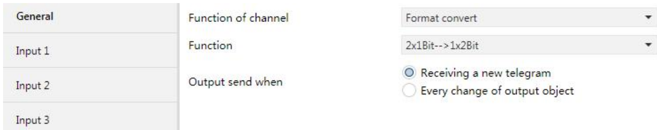
图 4.15 参数设置界面“Logic function -- Format convert”
