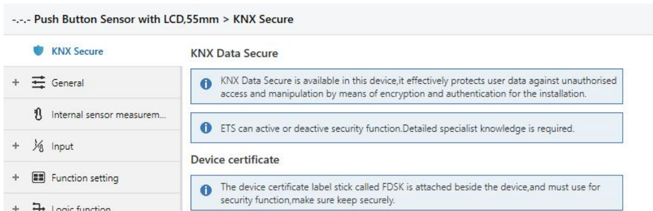
图 5.1 (1) “KNX Secure” 参数界面
